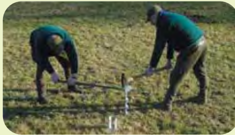
Bei steinigem Boden, gleichzeitig drehen und schlagen.
