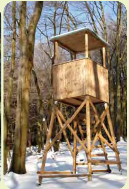
offene Kanzel mit 2,40 m Unterbau und Dach
